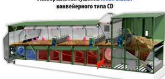
Универсальная сушилка Alvan Blanch конвейерного типа CD
