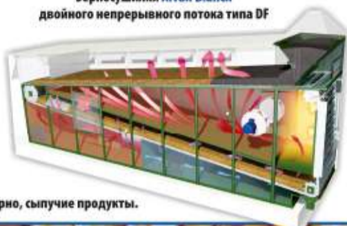
Зерносушилки Alvan Blanch двойного непрерывного потока типа DF
